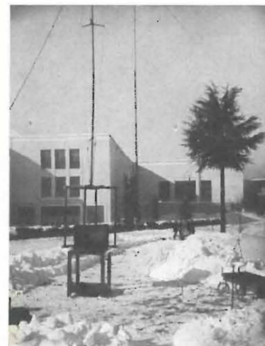
Apparecchiatura campale che consente di tracciare il diagramma azimutale dell'irradiazione parassita di un televisore, montata in un prato del Parco del Valentino a Torino scelto per le sue particolari caratteristiche radioelettriche.
